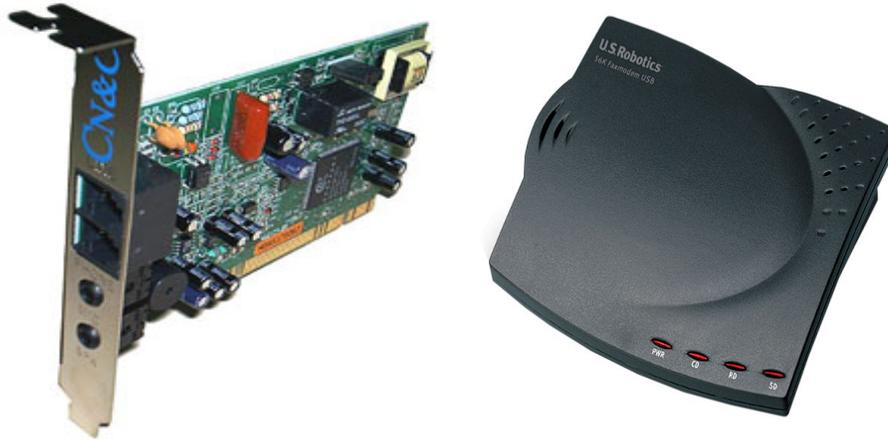
Figura 5.34: Modem Interno y Externo
