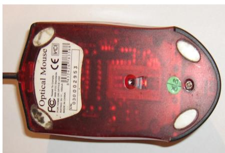
Figura 5.10: Parte inferior de un ratón óptico
