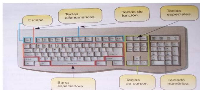
Figura 5.2: Partes de un teclado
