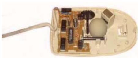
Figura 5.8: Partes de un ratón mecánico
