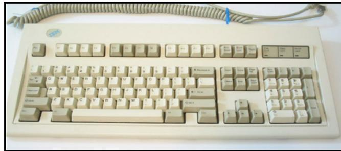
Figura 5.5: Teclado AT extendido de 103 teclas
