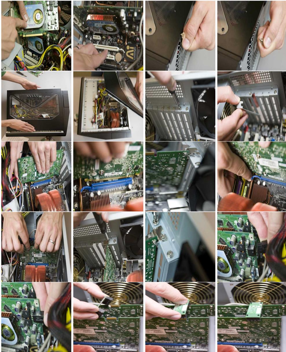
Figura 3.17: Instalación de dos tarjetas PCIexpress para un sistema SLI
