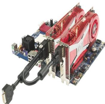
Figura 3.18: Dos tarjetas gráficas conectadas (Master y Slave) montadas en un sistema Crossfire
