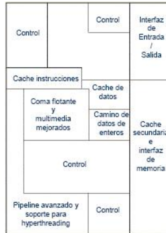
Estructura interna del Pentium 4 (3.0 GHz)
