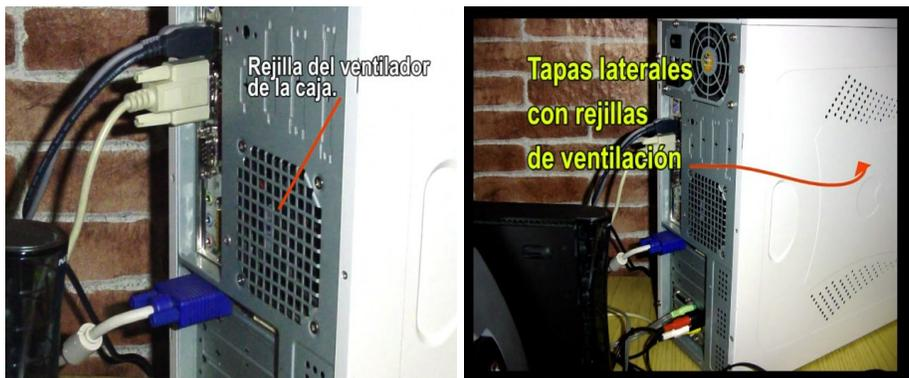
Figura 2.10: Rejilla del ventilador y tapas laterales
