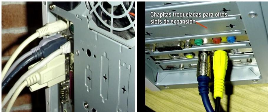
Figura 2.9: Puertos integrados en la placa base y tarjetas de expansión
