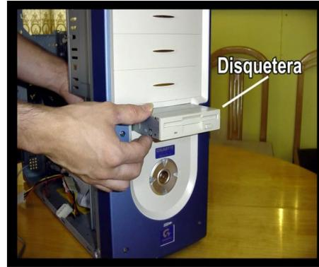
Figura 2.6: Diferentes Bahías de una caja      Figura 2.7: Bahía de la disquetera
