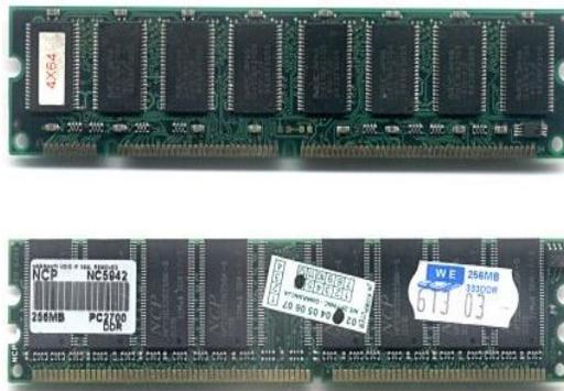
Figura 2.55: Módulos de memoria DIMM de 168 y 184 contactos
