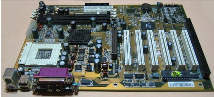
Figura 2.26: Placa base ABIT KT7 con formato ATX
