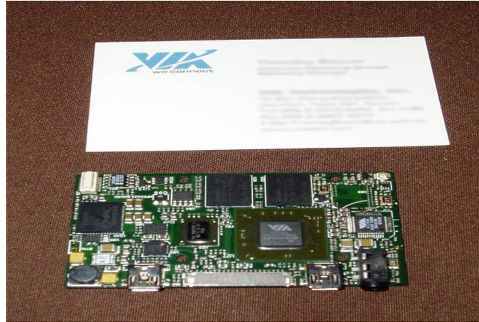
Figura 2.36: Placa para el formato Mobile-ITX
