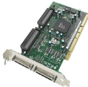
Figura 2.61: Tarjeta controladora SCSI
