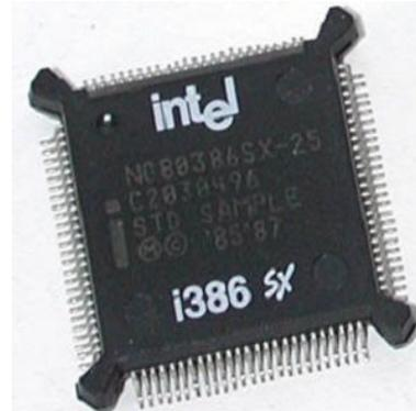
Figura 2.43: Encapsulado en QFP
