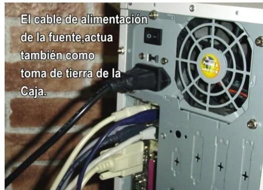
Figura 2.11: Cable de alimentación de la fuente
