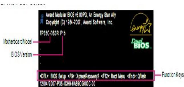
Figura 2.41: Pantalla de testeo (POST) de la placa base GA-EP35C-DS3
