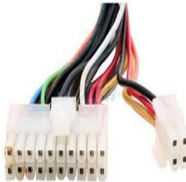
Figura 2.23: Conector ATX de 20 pines y alimentación de 4 pines
