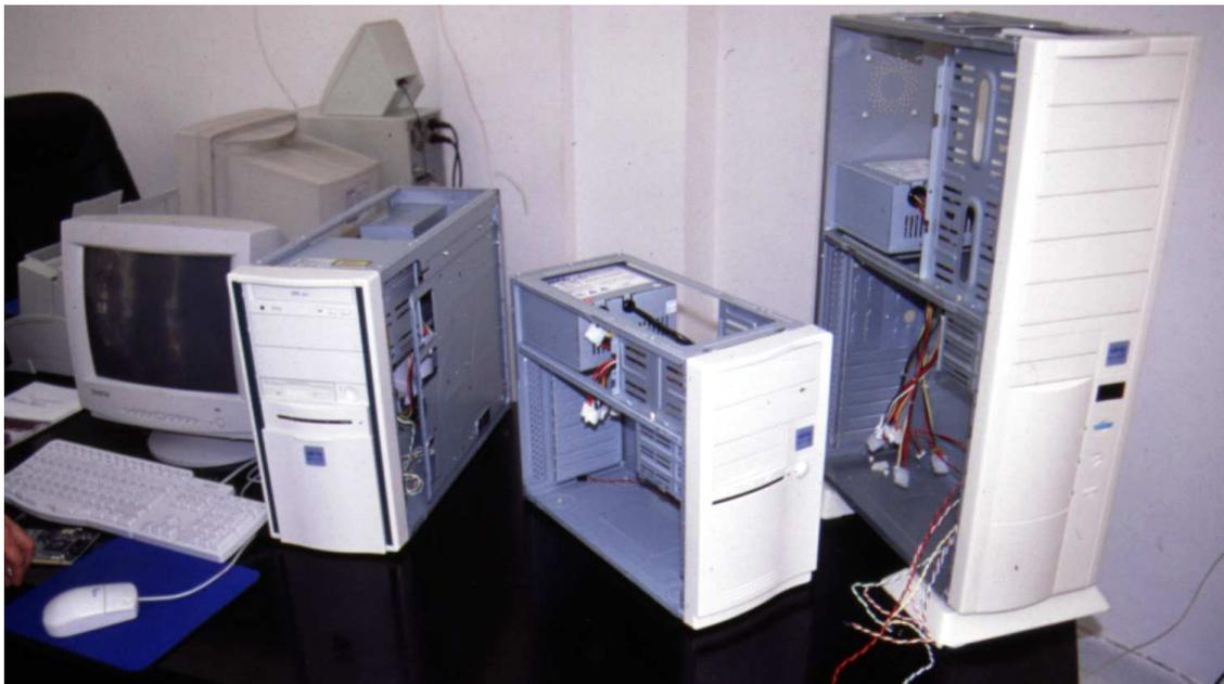
**FOTO 21.7:** Los tres tamaños de carcasas de tipo torre que coexisten en el mercado actual. Izquierda: Semitorre. Centro: Minitorre. Derecha: Torre completa.
