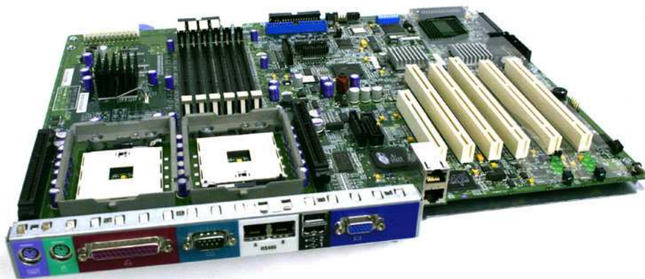
Placa madre con dos zócalos para microprocesadores
